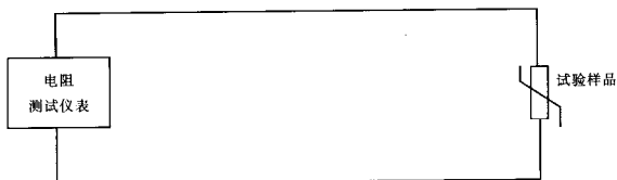
图 2 额定零功率电阻测试电路
